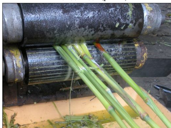
Рис. 1. Отжим сока из стеблей сахарного сорго на вальцовом станке.
