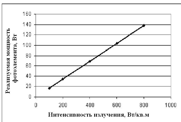
Рис. 5. Мощностная характеристика ФЭ на площадке СЭС.
