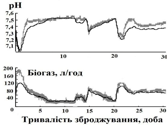
Рис. 3. Вихід біогазу та значення рН середовища у вересні 2001 року для промислової біогазової установки Стейєра.
