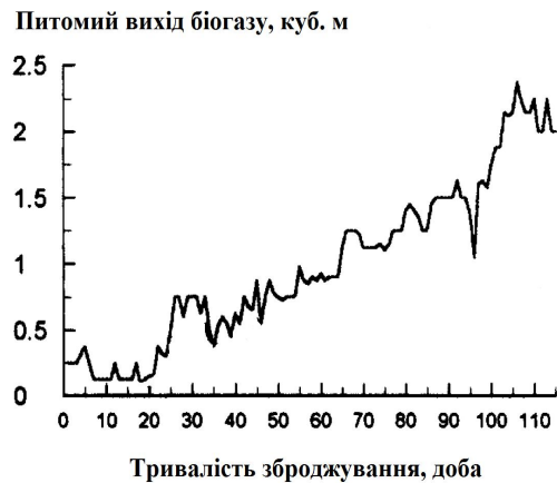
Рис. 1. Питомий вихід біогазу для лабораторної біогазової установки К'елі.
