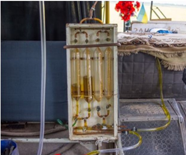
Рис. 2. Об'ємний витратомір, підключений до системи живлення автобуса.
