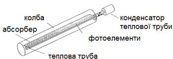
Рис. 10. Конструкція КСК на основі вакуумного сонячного колектора з ТТ [38].
