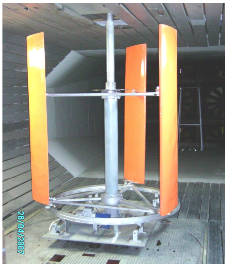
Рис. 2. Ветрогенератор ИГМ-1 (2007 г.) с механизмом управления №1 в аэродинамической трубе НАУ.
