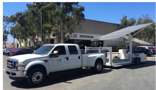
Рис. 9. Приклади зарядних станцій електротранспорту від фотоелектричних батарей компанії Envision solar: а – потужністю 3,4 кВт; б – 4,1 кВт; в – цифрова зарядна станція; г – мобільна зарядна станція.
