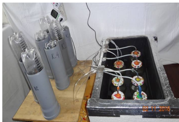
Рис. 2. Схема та фото експериментальної установки: 1 – термостат; 2 – реактори; 3 – евідіометри; 4 – датчики тиску; 5 – газоаналізатор; А – субстрат; В – біогаз; С – розчин кухонної солі.
