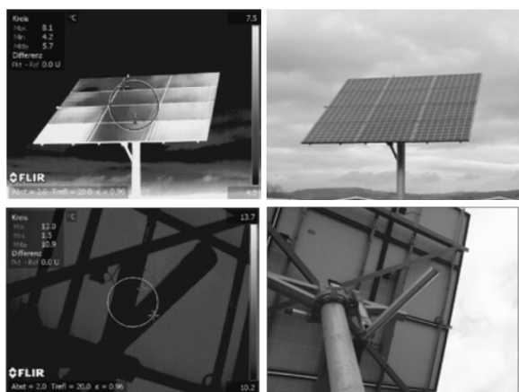
Рис. 4. Гарячі ділянки ФЕ модулів з лицьового та зворотного боків.
