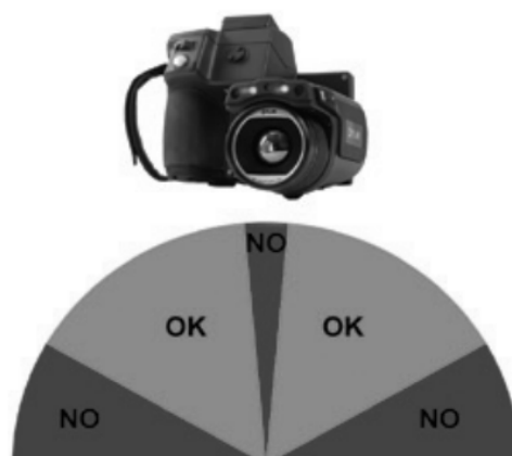
Рис. 3. Рекомендований (зелений) та нерекомендовані (червоний) кути зйомки під час термографічних оглядів.
