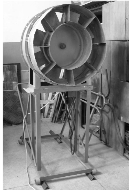
Рис. 2. Схема та загальний вигляд пересувного вентилятора: 1 – асинхронний двигун з крильчаткою; 2 – кожух; 3 – дифузор; 4 – блок керування; 5 – рама опорна; 6 – ручка; 7 – ролики.
