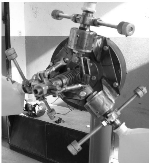
Рис. 6. Загальний вигляд маточини з відцентровими тягарцями.
