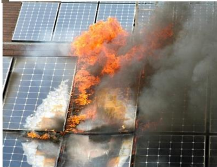
Рис. 1. Приклад дії деградаційних змін у фотоелектричних модулях ФЕС
