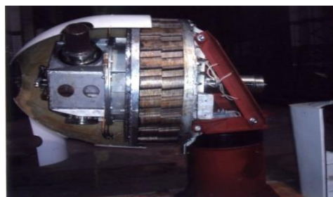
Рис. 3. Виготовлений безкорпусний безредукторний генератор для вітроустановки
