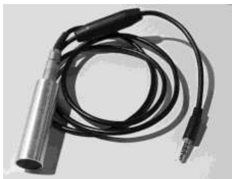
Рис. 3. Досліджуваний ВСП подвійного диференціювання типу МДФ 1501 з кабелем для підключення до смартфона з блоком імітації гарнітури.
