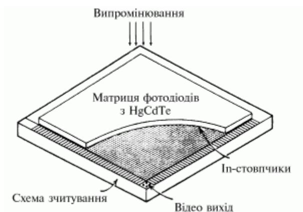
Рис. 2. Багатоелементний гібридний ФПП з матрицею фотодіодів з HgCdTe і кремнієвою схемою зчитування.
