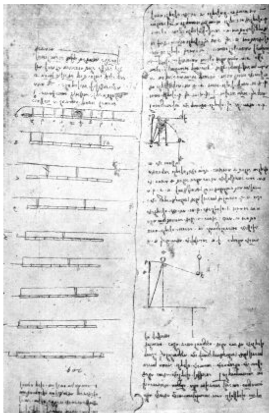
Аркуш з «Античного кодексу», де описані досліди з навантаженням, яке балка передає на опори
