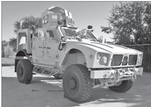
Рис. 5. Бронетранспортер, оснащенный прозрачной броней на основе сапфиростеклопакетов
