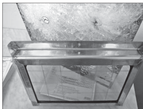
Рис. 4. Окно 500 × 500 мм 2 . На заднем плане — окно после попадания трех пуль
