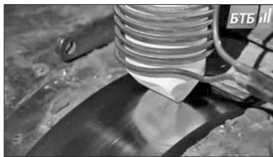
Рис. 1. Схема процесу спінінгування розплаву та напівпромислова установка виготовлення аморфної стрічки
