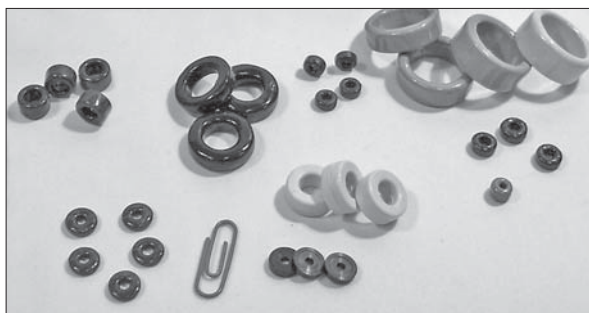
Рис. 13. Мініатюрні тороїдальні магнітопроводи (МТ) для трансформаторів і дроселів телекомунікаційних систем
