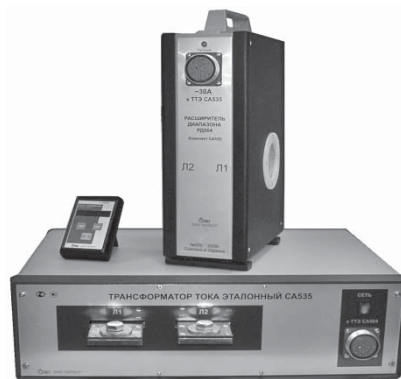
Рис. 12. Еталонний трансформатор струму на основі нанокристалічних магнітопроводів
