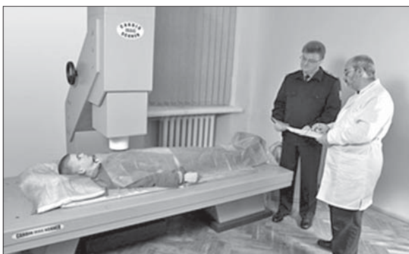
Магнітокардіографічна система на основі SQUID-сенсорів для обстеження стану серцево-судинної системи пацієнта
