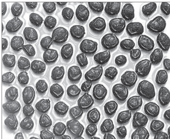
Рис. 1. Зовнішній вигляд вуглемазутних гранул-агломератів. Середня крупність гранул 3–5 мм
