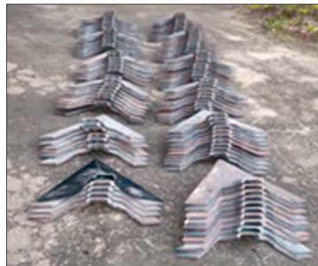
Рис. 7. Дослідна партія литих лап культиваторів для ПП «Агроекологія»
