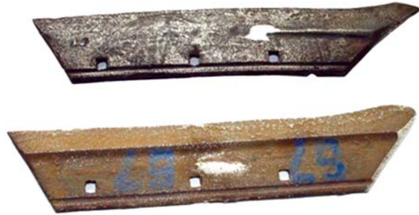
Рис. 6. Лемеші з різною конфігурацією ребер жорсткості
