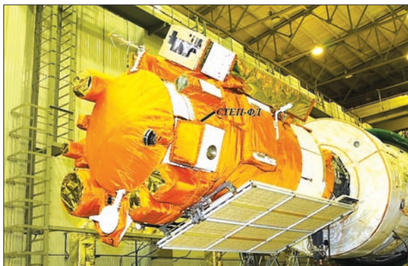
Рис. 8. Космічний комплекс «КОРОНАС-Фотон» перед накатуванням обтічника в монтажно-випробувальному корпусі космодрому «Плесецьк». На передньому плані космічного апарата — зовнішній блок детекторів СТЕП-ФД приладу СТЕП-Ф
