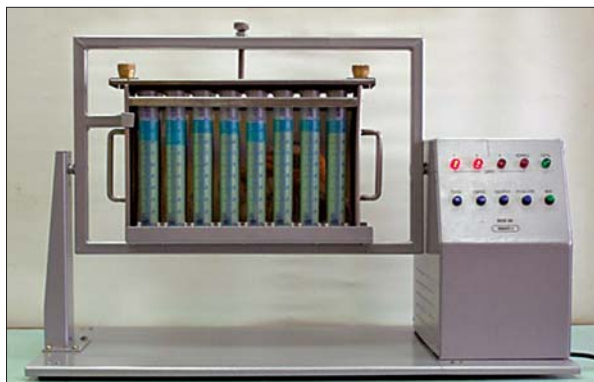
Рис. 7. Напівавтоматичний мікропроцесорний прилад для визначення хлібопекарської якості борошна пшениці на ранніх етапах селекції методом двохетапної седиментації SDS-30
