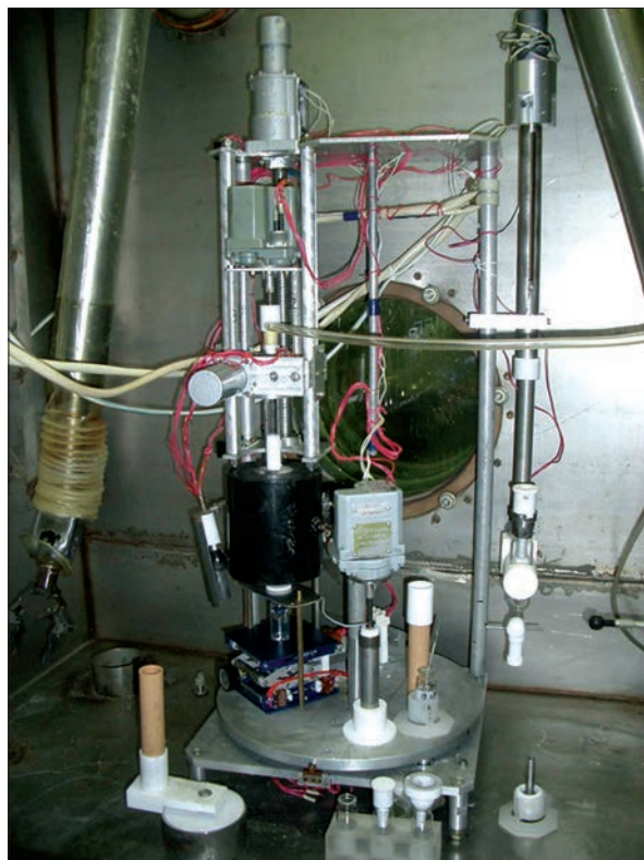
Рис. 4. Установка для виробництва капсул натрію йодиду ( ^{131}\text{I} )
