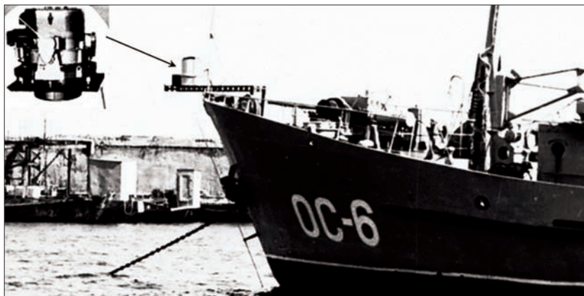
Рис. 6. Корабель із встановленим на ньому тепловізором
