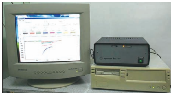
Прилад для детектування наявності летких токсичних сполук у повітрі — «Електронний ніс»
