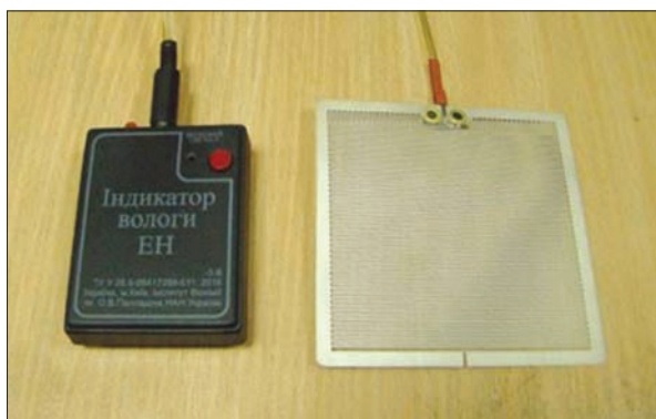
Сенсорний прилад для аларм-терапії «Індикатор вологи ЕН»
