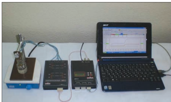
Біосенсор для визначення лактози, мальтози, сахарози і глюкози в харчових продуктах
