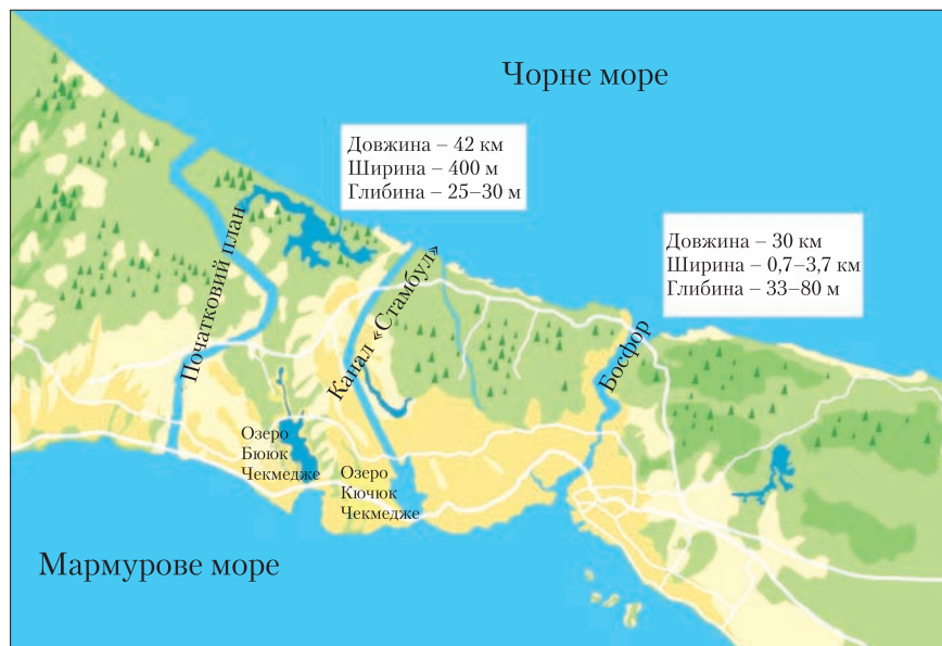
Рис. 2. Карта-схема будівництва нового судноплавного каналу «Стамбул» (праворуч — сучасний Босфор, ліворуч — попередній маршрут прокладання каналу)
