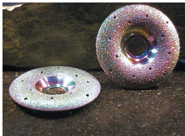
Рис. 2. Алмазні інструменти на гальванічних зв'язках для різання, шліфування та полірування неметалічних матеріалів
