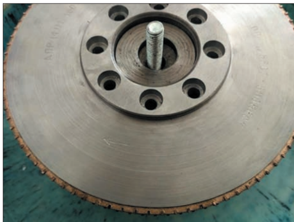
Правильний інструмент зі CVD-алмазу для шліфування високоточних зубчастих коліс спеціальних редукторів
