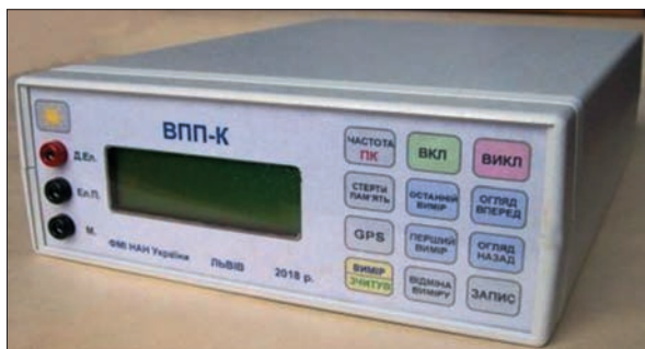
Вимірювач поляризаційного потенціалу для контролю захисту від корозії підземних трубопроводів і металевих споруд
