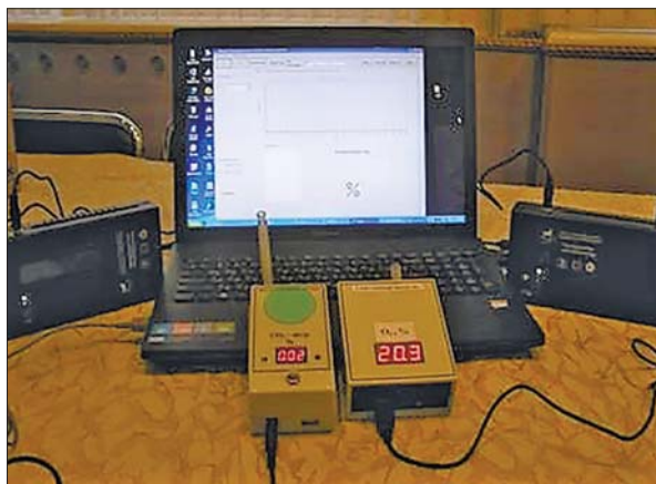
Рис. 8. Мультисенсорний газоаналізатор на \text{CO}_2 , \text{O}_2 , \text{CO} для діагностики стану здоров'я людини за складом повітря, яке вона видихає
