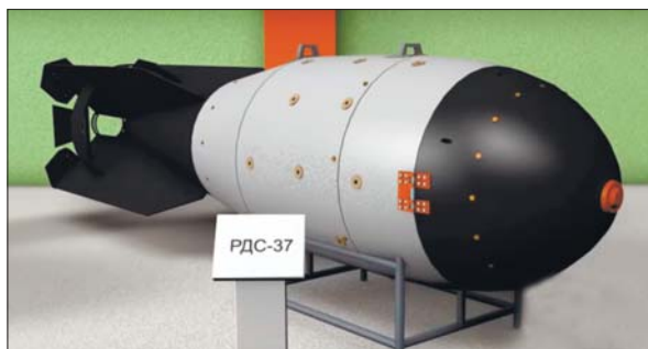
Макет термоядерної бомби РДС-37; випробування проведено 22 листопада 1955 р. на Семипалатинському полігоні; половинна потужність заряду — 1,6 Мт
