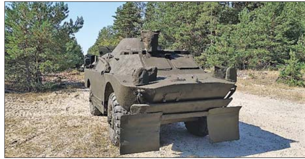
Рис. 10. Розвідувально-дозорна машина БРДМ-2 з нанесеним антирадарним покриттям на полігонних випробуваннях
