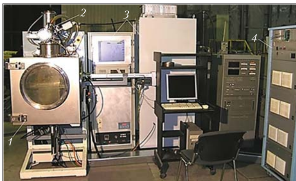
Рис. 8. Обладнання для пошарового виготовлення об'ємних виробів складної форми методом електронно-променевого друку
