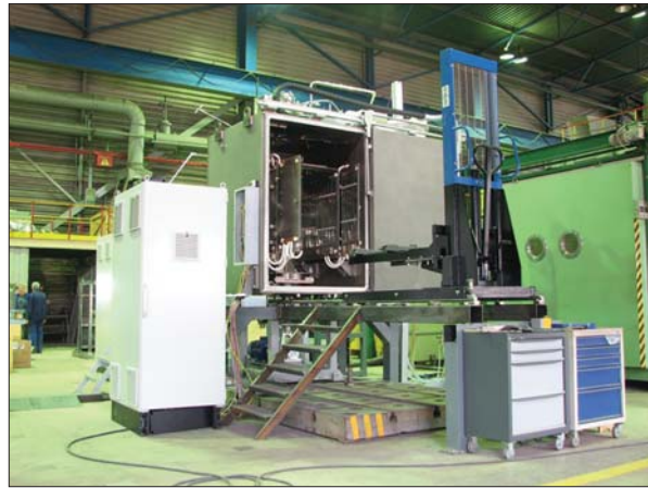
Рис. 6. Спеціалізована електронно-променева зварювальна установка для гранульної металургії
