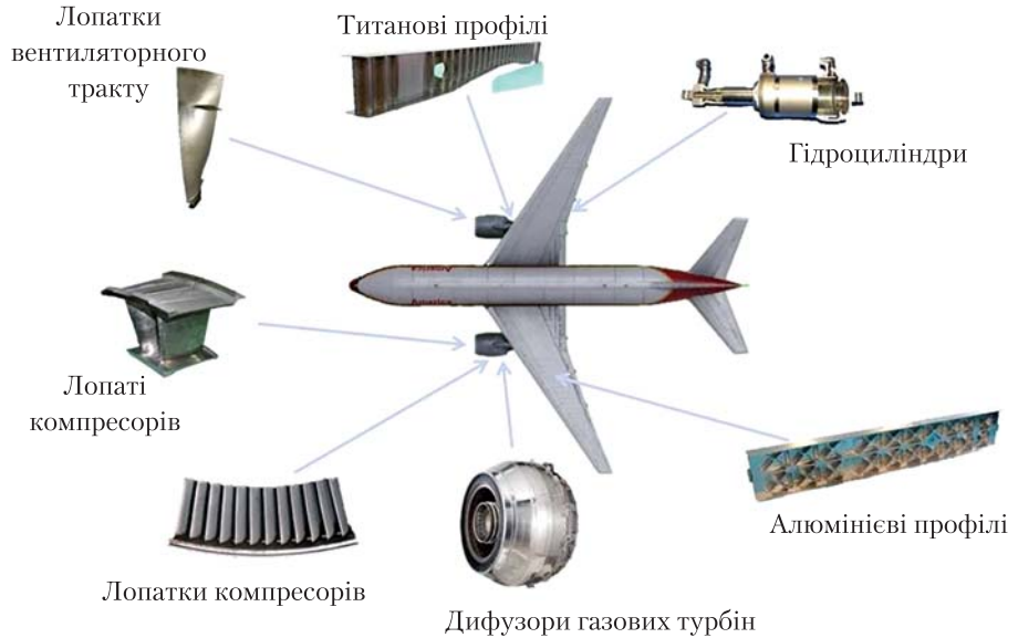
Рис. 9. Застосування технології електронно-променевого зварювання в авіабудуванні
