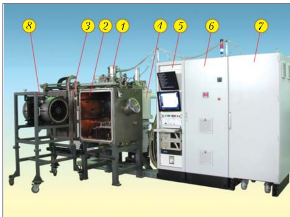
Рис. 7. Обладнання для електронно-променевого спікання тврдосплавних заготовок: 1 – електронно-променева гармата; 2 – вакуумна камера; 3 – двері; 4 – вакуумна система; 5 – шафа керування; 6 – силова шафа; 7 – шафа джерела живлення; 8 – завантажувальний пристрій
