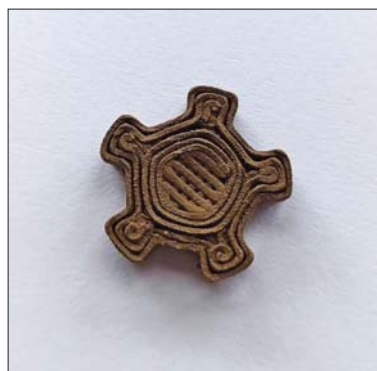
Рис. 4. Шестерня, надрукована методом пошарового наплавлення з композиту ПП-TiN [26]
