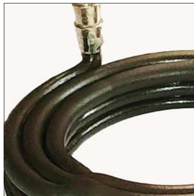
Рис. 3. 3D-друк методом робокастингу пастою на основі \text{MoSi}_2
