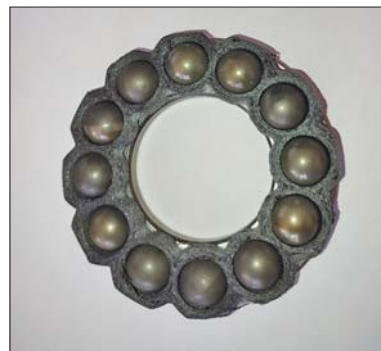
Рис. 1. Керамічні кульки на основі \text{Si}_3\text{N}_4\text{-ZrN} у сепараторі, надрукованому на 3D-принтері
