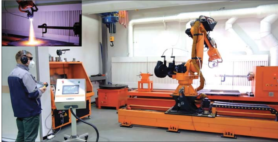
Рис. 1. Роботизований комплекс для нанесення зносостійких, корозійностійких, теплозахисних і спеціальних покриттів методами високошвидкісного плазмово-дугового наплення
