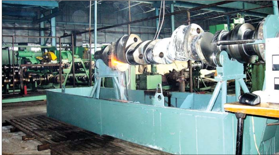
Рис. 2. Процес плазмово-електролітної обробки шийки дизельного колінчастого вала (довжина 5 м, маса до 2000 кг)
