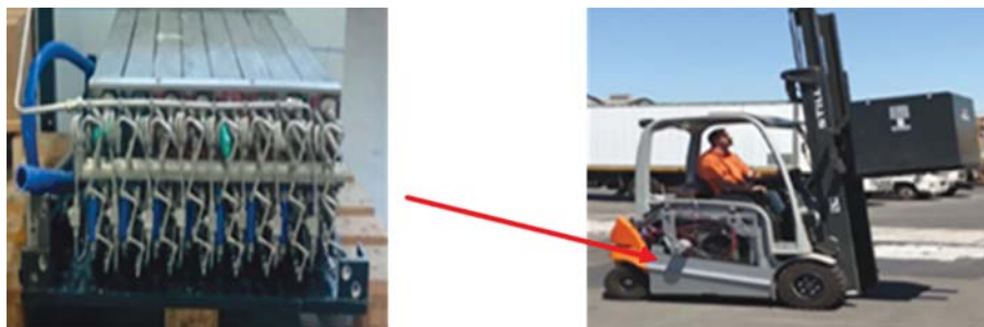
Рис. 2. Акумулятор водню з паливним елементом, встановлений на автотранспортному засобі
