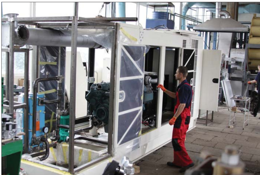
Рис. 1. Виготовлення промислової біогазової електростанції на дослідному виробництві Інституту газу НАН України
