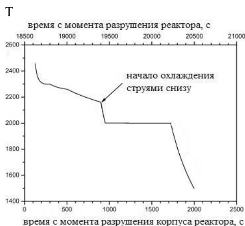
Рис. 6. Изменение температуры расплава GEMINI-2 (слева) и по компьютерному коду MELCOR.
