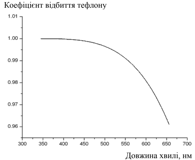
Рис. 4. Крива спектральної залежності коефіцієнта відбивання тефлонової плівки від довжини хвилі.
