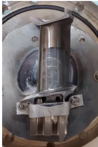
Рис. 2. Зразок опроміненої лопатки ГТД.
