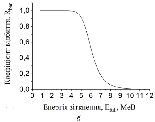
Рис. 3. Коефіцієнти проникності (а) та відбиття (б) залежно від енергії відносного руху ядер у реакції ^{12}\text{C} + ^{12}\text{C} . Коефіцієнти порашовано незалежно; потенціал та параметри визначено в рівняннях (29) - (31).
