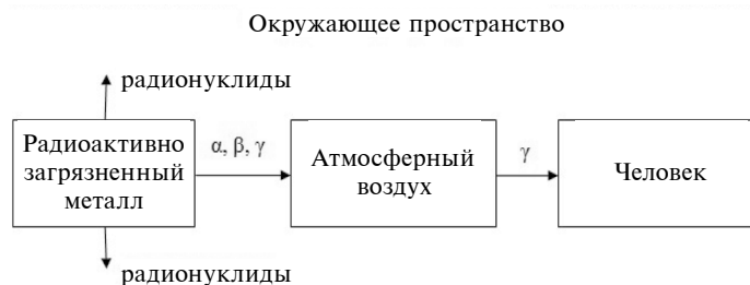
Рис. 1. Схема поступления ионизирующего излучения от радиоактивно загрязненного металла к человеку
