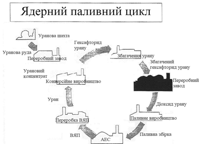
Рис. 1. Технологічні складові паливного циклу РТН
