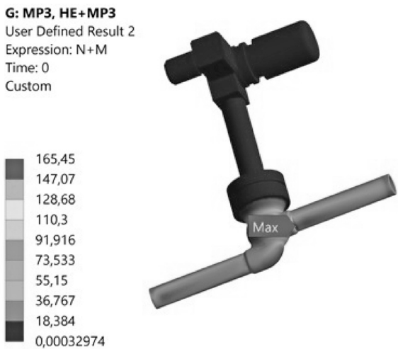
Рисунок 3 — Результати розрахунку напружень в корпусі арматури YP13S02 на енергоблоці № 3 ВП ЗАЕС
