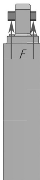
Рисунок 5 — Розрахункова модель балки ферми опорної
