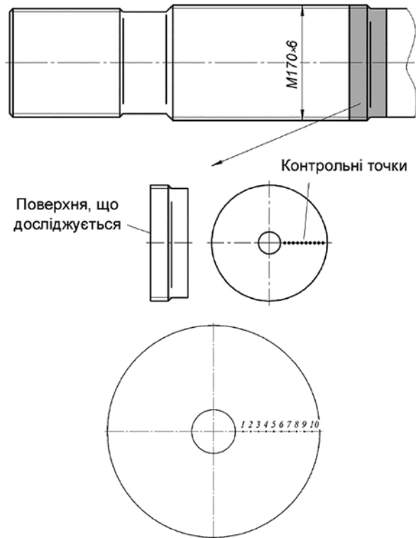
Рисунок 9 – Схема вирізки зразків та розташування контрольних точок для вимірів твердості за перетином шпильки
