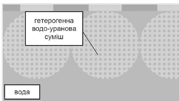
Рисунок 10 – Модель гетерогенної водо-уранової суміші під опорною плитою відсіку БВ
