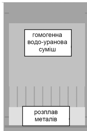
Рисунок 6 – Переріз відсіку БВ з гомогенною водо-урановою сумішшю у разі утворення зависі
