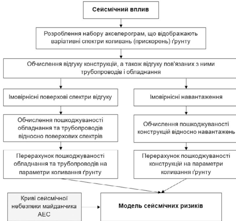
Рисунок 4 – Блок-схема визначення параметрів кривих пошкоджуваності КСЕ методом моделювання (на основі [6])
