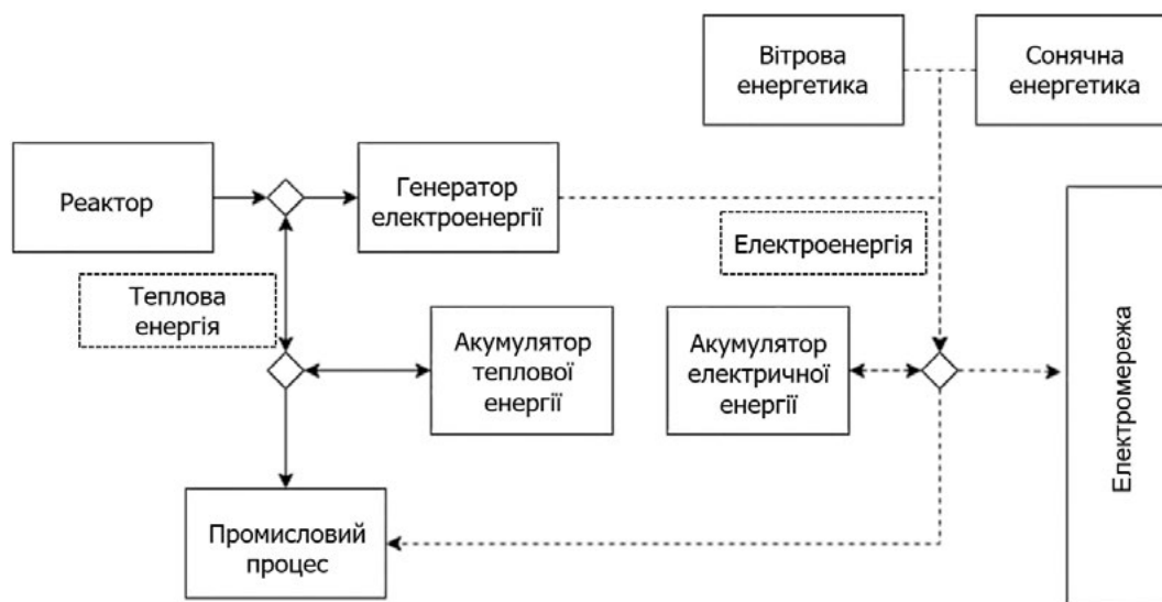
Рисунок 3 – Принципова схема ядерно-відновлювальної гібридної енергетичної системи [6]
