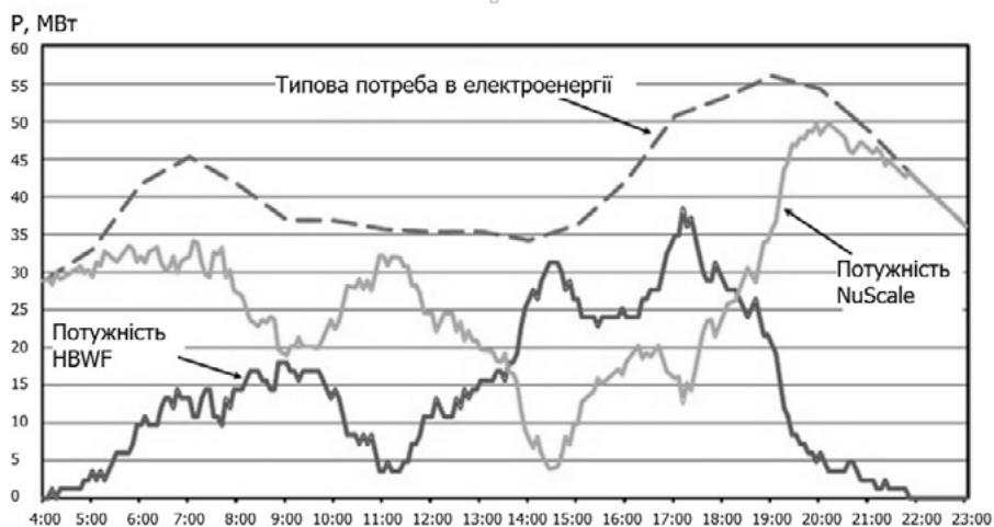
Рисунок 1 – Приклад маневреності ММР NuScale VOYGR для компенсації добової зміни генерації від вітрової електростанції HBWF [8]
