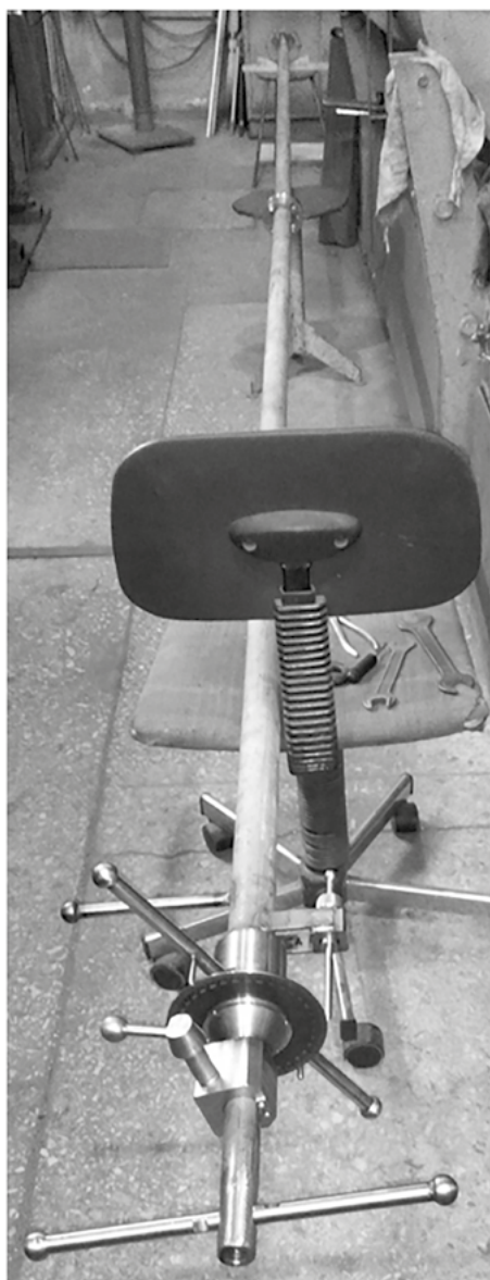
Рисунок 12 – Пристрій, призначений для встановлення заданої орієнтації КЗ відносно центральної осі реактора
