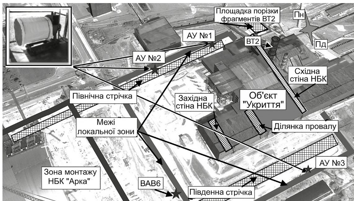
Рисунок 1 — Схема розташування пунктів відбору РА та ділянок проведення окремих заходів у локальній зоні під час спорудження нового безпечного конфайнмента
